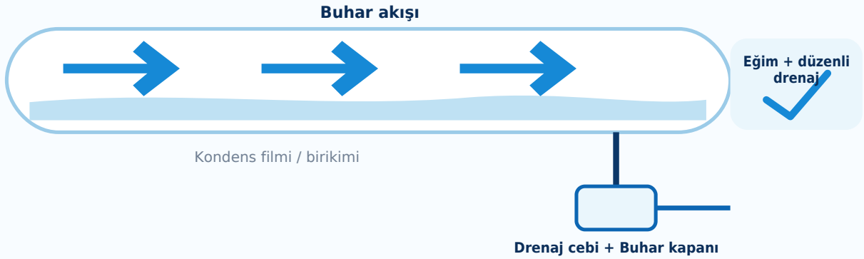
Şekil 3 · Buhar ana hattında kondens oluşumu, taşınması ve drenajın prensip gösterimi.
