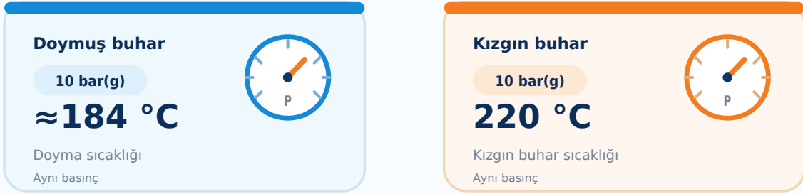
Şekil 4 · 10 bar(g) için doymuş ve kızgın buharın kavramsal karşılaştırması.
