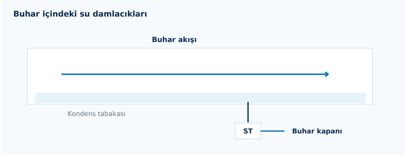
Şekil 2 · Buhar hattı, biriken kondens ve buhar kapanının prensip gösterimi.
