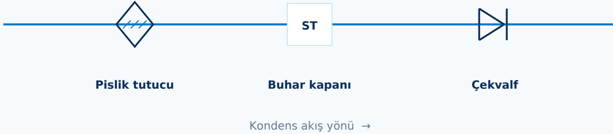
Şekil 1 · Kondens hattında pislik tutucu, buhar kapanı ve çekvalfin kavramsal sıralaması.
